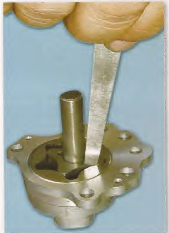
Verificación de desgastes del cuerpo de la bomba
